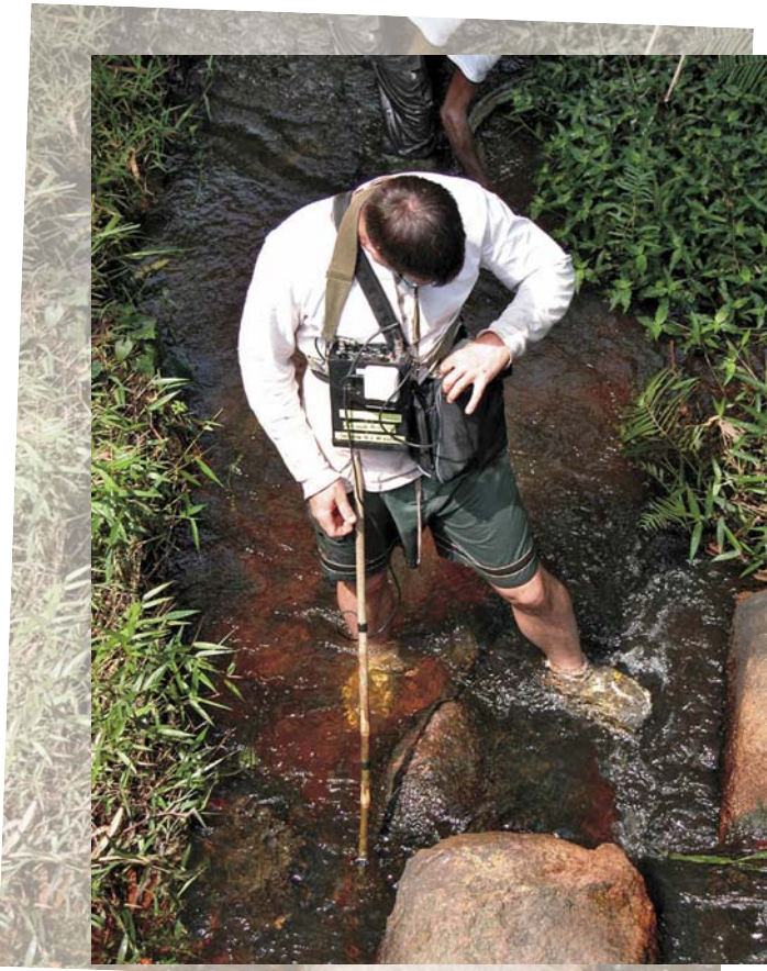
В небольших речушках исследователи отслеживают особей мормирусов нужного вида и пола с помощью электрода, усилителя и осциллографа. Фото П. Макинтайра
